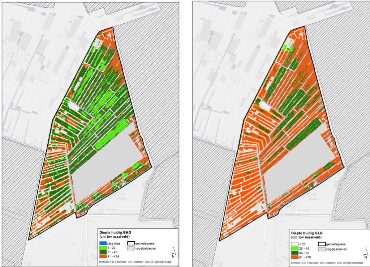
Figuur 4-5 Grondwaterregime De Wijk: ontwateringsdiepte bij GHG (links) en GLG (rechts) in cm ten opzichte van maaiveld bij een peil van NAP -2,29 m
