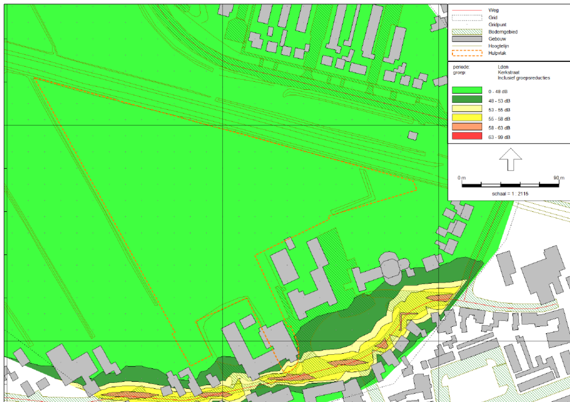
Figuur 4.10 Geluidcontouren Kerkstraat waarneemhoogte 7,5 meter
