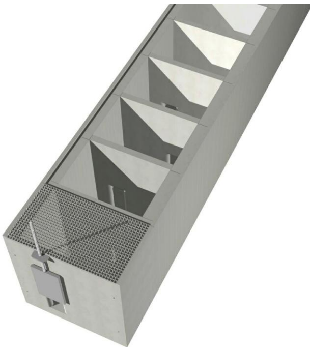
Figuur 6 Bypass door rechthoekige goot met schotten met daarin afwisselend links en rechts openingen waardoor de vis kan zwemmen
