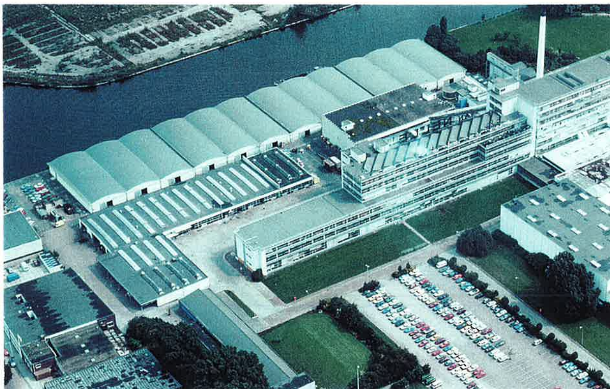
afb. 7. Op deze foto uit 1986 zijn de nieuwe lichtstraten te zien naast de oorspronkelijke. In de periode 1966-76 is de rest van de loods aan de timmermanswerkplaats gesloopt. De luifel in de binnenhoek van de gevels langs de Fabrieksstraat is aangebracht. (VNHA, foto: Geosens 87 RD 05-8)
