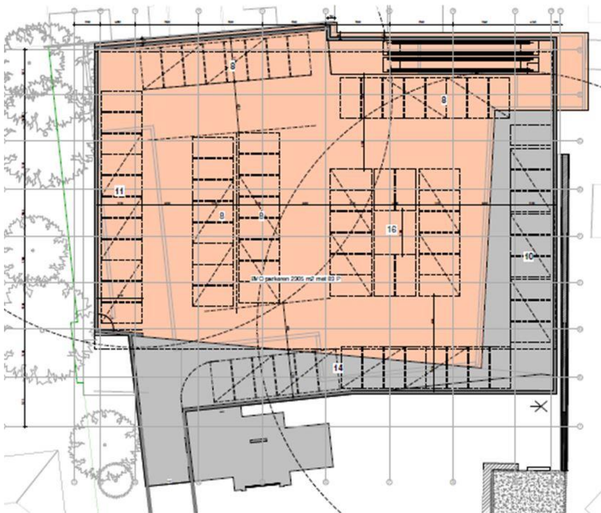
Overzicht parkeerplaatsen (bron: D&M Architecten Adviseurs)
