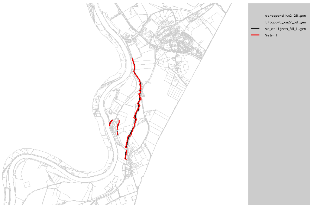
Figuur 3.9 WAQUA-modellering as-verlegging dijken Grevenbicht – Visserweert – Illikhoven - Roosteren
