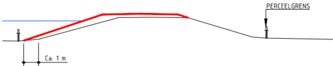
Figuur 8.9: Dwarsprofiel dijkvak 50.540.6
