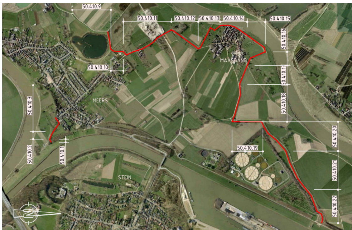
Figuur 2.1: Locatie te versterken dijkvakken
