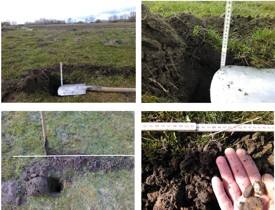
Figuur 3.1: Resultaten boring dijkvak 50.410.15
