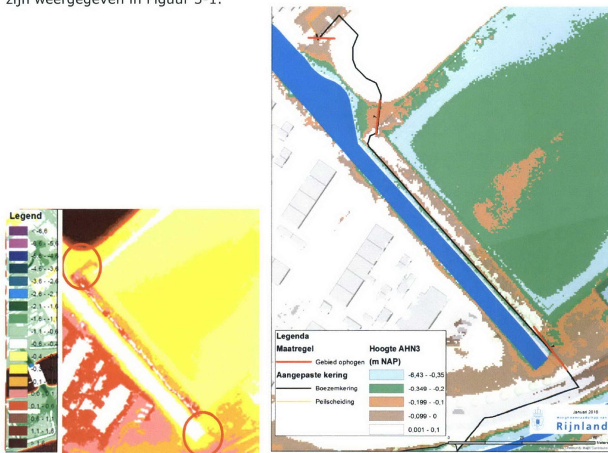
Figuur 3-1 Locaties (rood omcirkeld links) waar te weinig hoogte aanwezig is om de kering alleen 'administratief' aan te kunnen wijzen
