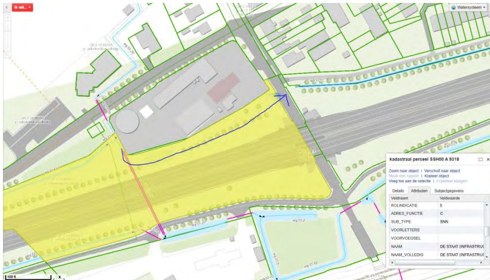
Figuur B3.1: Schets van verbinding (watergang en/of duiker) waarmee een groot deel van Peilvak 1.2 rechtstreeks naar Peilvak 1.1 kan stromen, zonder tweemaal de duikers onder de A44 te hoeven gebruiken.
