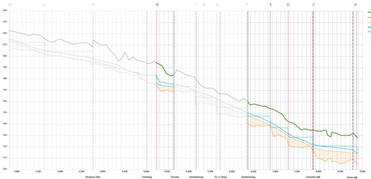
Figuur 5.1a. Huidige en nieuwe zomer waterstanden. Het gedeelte waar dit projectplan betrekking op heeft is gekleurd weergegeven. Oranje lijn = huidige bodem, oranje vlak = bodemophoging, blauwe streepjes lijn = huidige waterstand, blauwe doorgetrokken lijn = nieuwe waterstand, groene lijn = maaiveld direct naast de beek.
