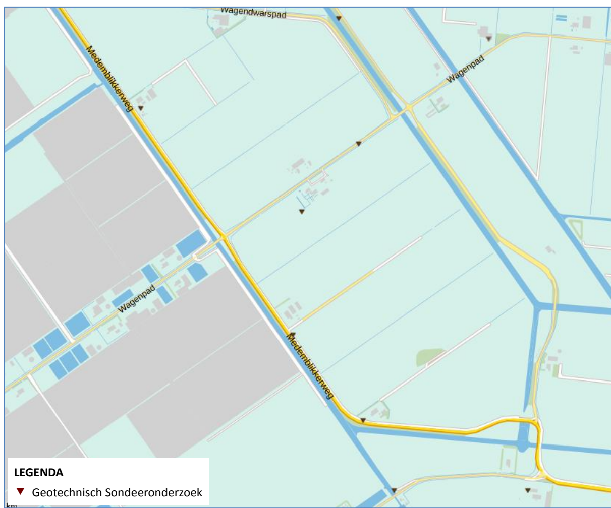
Figuur 29: Overzicht van de bij het DINOloket geraadpleegde geotechnische sondeeronderzoeken in de nabijheid van het verdachte gebied.
