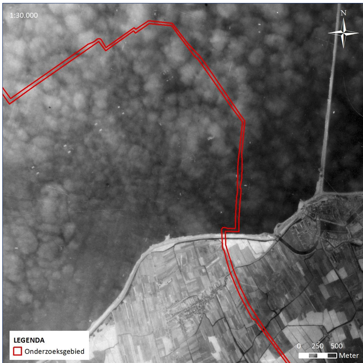
Figuur 21: Detail van een luchtopname van 12 mei 1945 ter hoogte van de Wieringermeer en Opperdoes. De opname toont de overstroomde Wieringermeer. De Duitsers lieten op 17 april '45 de dijken springen waardoor de gehele polder onder water kwam te staan. Op de foto is te zien dat in de Wieringermeer diverse boerderijdaken nog boven het waterpeil uitkomen.
