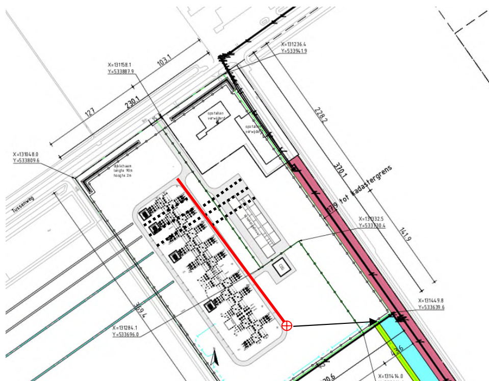
Figuur 1: Principeontwerp bemaling (verzamelleiding- en put rood, drainage zwart gestippeld gedeeltelijk weergegeven)
