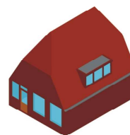
geen dakkapel op wolfseind, maar op zijdakvlak
