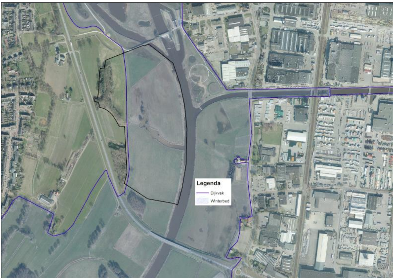
Figuur 7: winterbed van de Vecht. De paarse lijn betreft de regionale waterkering, het blauw gearceerde gedeelte betreft het stroomvoerende winterbed
