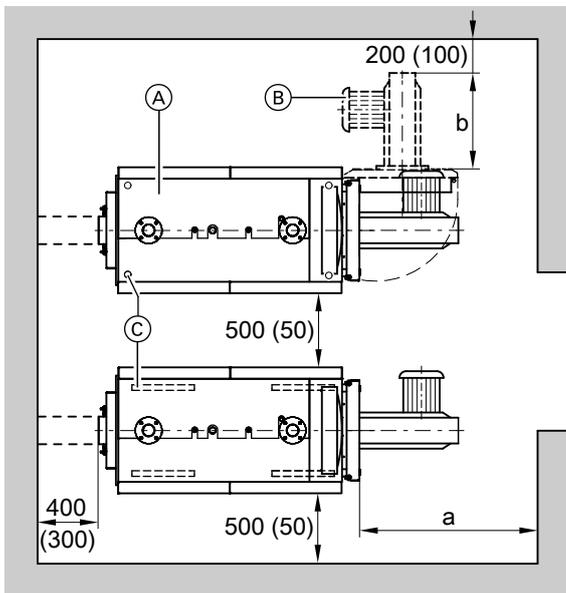
Zur einfachen Montage und Wartung sollten die angegebenen Maße eingehalten werden; bei beengten Platzverhältnissen müssen nur die Mindestabstände (Maße in Klammern) eingehalten werden. Im Auslieferungszustand ist die Kesseltür nach links ausschwenkbar angebaut. Die Scharnierbolzen können so umgesteckt werden, dass die Tür nach rechts ausschwenkt.
