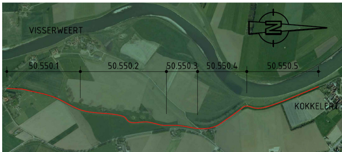
Figuur 2.1: Locatie te versterken dijkvakken
