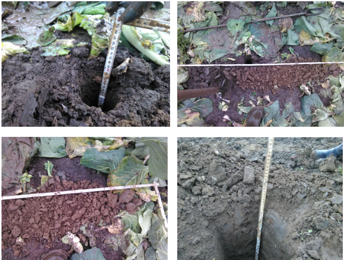
Figuur 3.3: Resultaten boringen dijkvak 50.550.3
