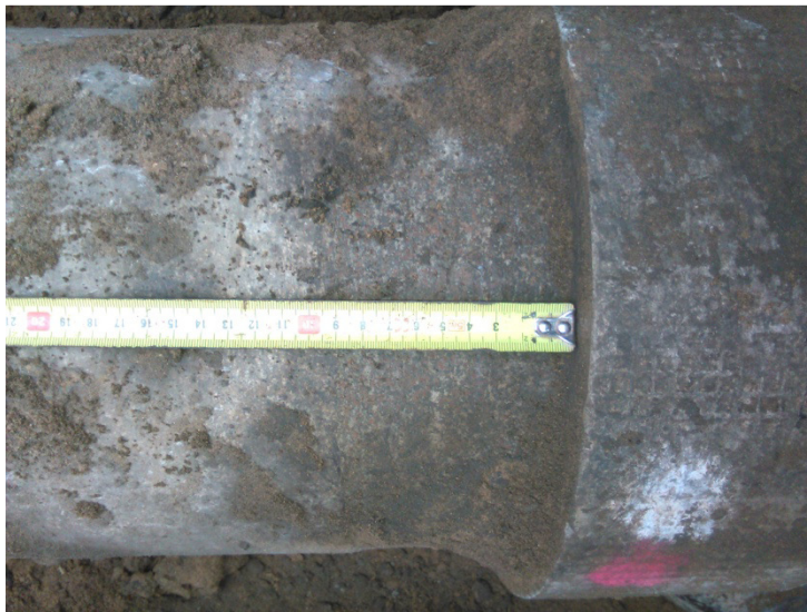
Figuur 6 Komeetkoppeling, L = 13 cm
