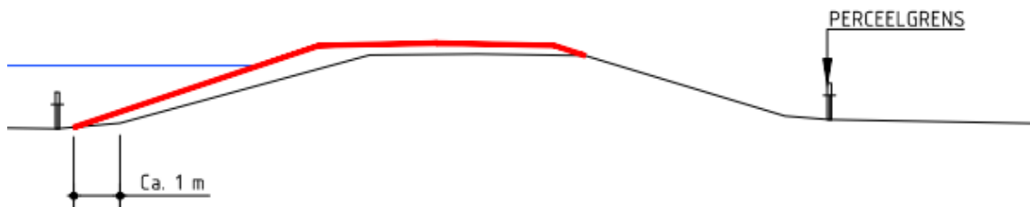
Figuur 8.9: Dwarsprofiel dijkvak 50.540.6
