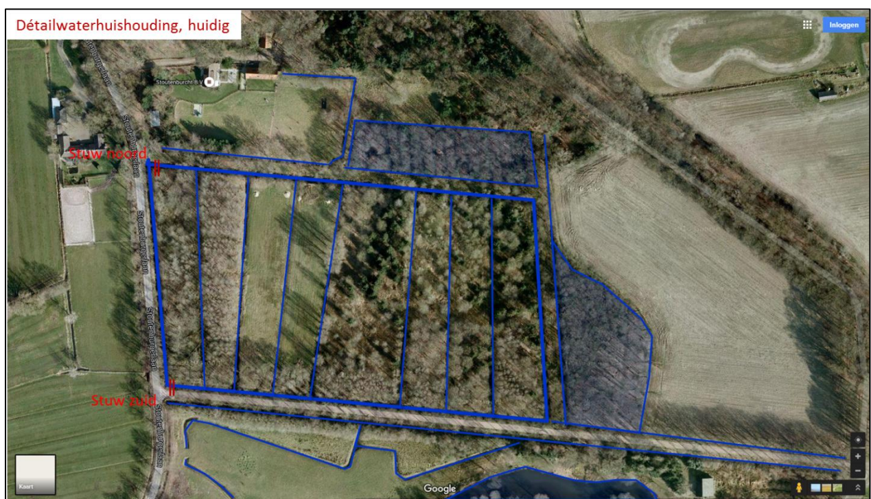
Figuur 14. Detailwaterhuishouding zoals aangetroffen bij veldbezoek 15 januari 2016. De stuwen zijn regelbaar. Peilschalen ontbreken, zodat hun actuele kruinhoogte niet af te lezen was. De sloten in de 2 'rabattenbossen' (noord en oost) lijken via duikers gekoppeld aan die van het broekboscomplex. De sloot rondom het weiland van Stoutenburgerlaan 11, het huis ten N van het broekboscomplex, lijkt een apart systeem dat ergens aantakt op de wegsloot.
