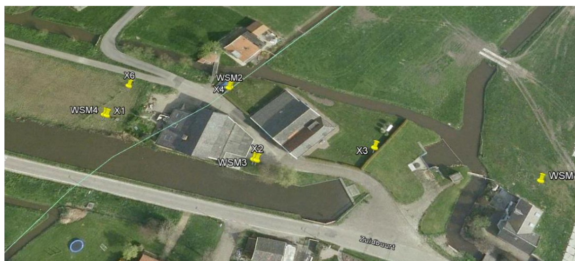
Figuur 4-2: Locaties peilbuizen en waterspanningsmeters (oorspronkelijke locaties) (bron: Google Earth)
