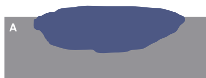
Betonvloer A: Deze vloer is nog vloeistofdicht omdat de ingedrongen vloeistof de onderkant van de betonvloer nog niet heeft bereikt.
