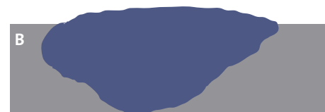
Betonvloer B: Deze vloer is niet meer vloeistofdicht omdat de vloeistof de onderzijde van de vloer wel heeft bereikt. De bodem kan nu worden vervuild.
