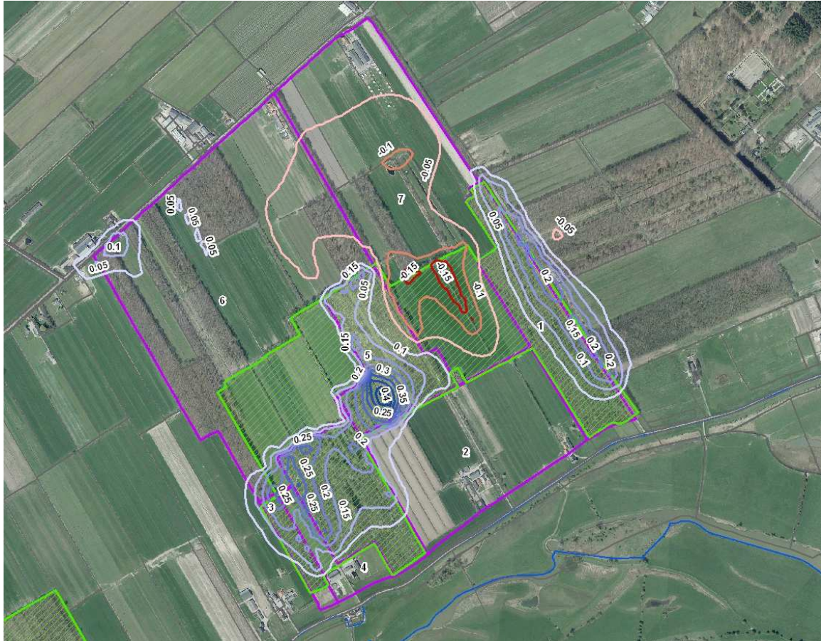
Figuur 4: Effect van de maatregelen op de grondwaterstand in de GVG situatie (Gemiddelde Voorjaars Grondwaterstand).
