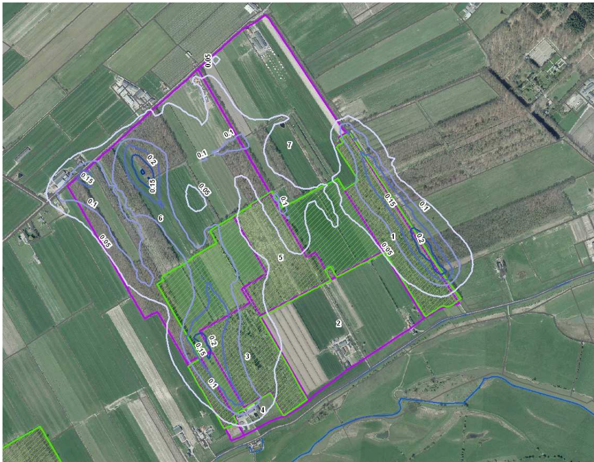
Figuur 5: Effect van de maatregelen op de grondwaterstand in de GLG situatie (Gemiddelde Laagste Grondwaterstand).
