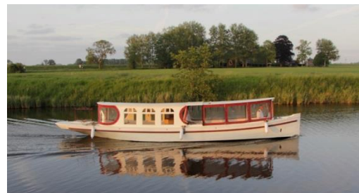
Opbouw volgt de zeeglijn van het casco
