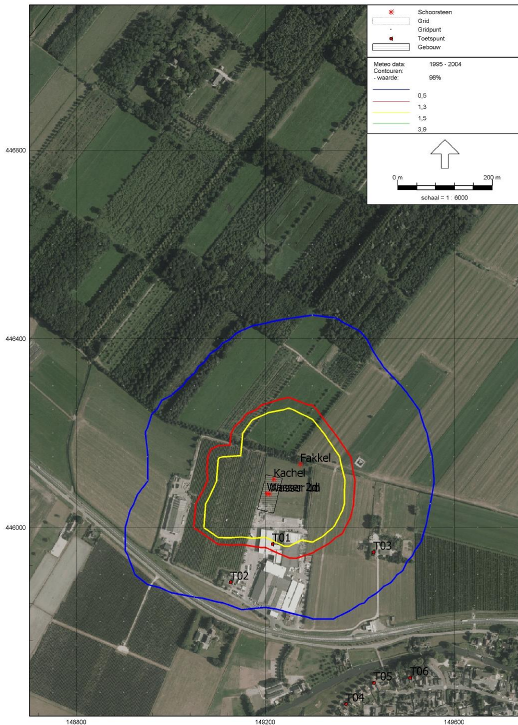
Figuur a Geurcontouren van 0,5, 1,3 en 1,5 ou E /m 3 als 98-percentielwaarde als gevolg van mestverwerkingsinstallatie Stichting Groene energie Krommerijn en Heuvelrug te Cothen
