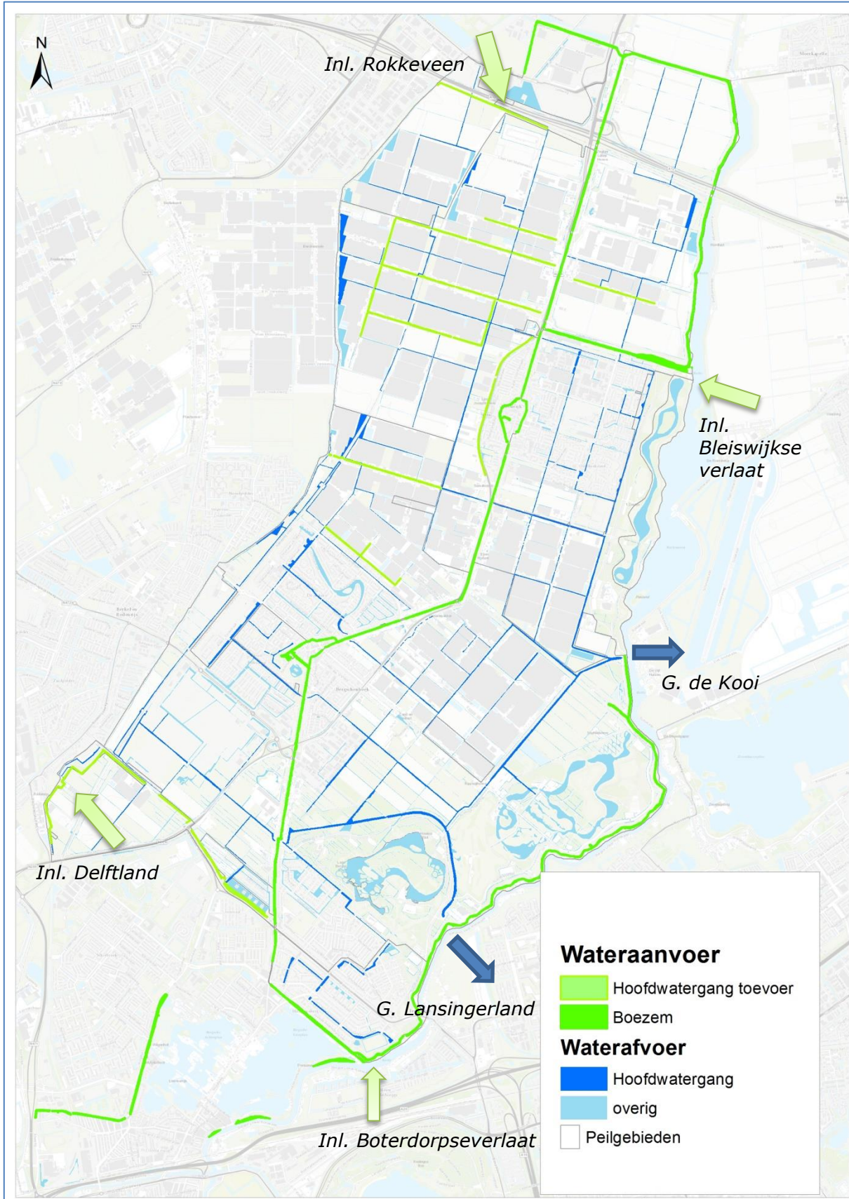
Figuur 3 schematische weergave watersysteem Bleiswijk
