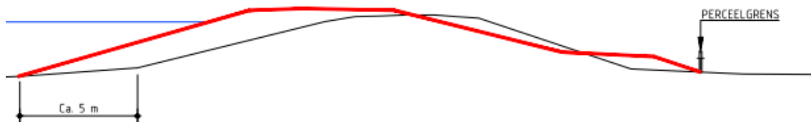
Figuur 9.9: Dwarsprofiel dijkvak 50.550.4
