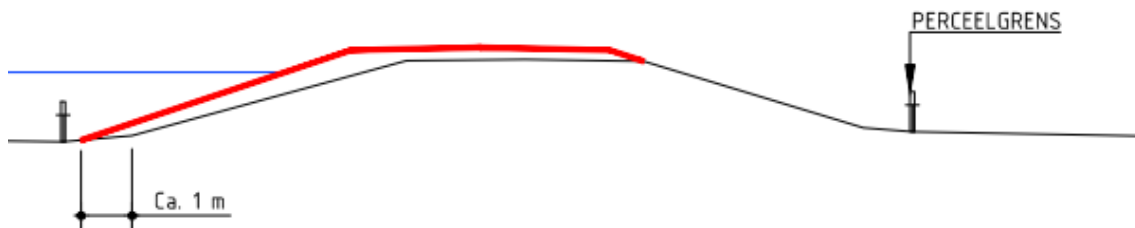
Figuur 8.9: Dwarsprofiel dijkvak 50.540.6
