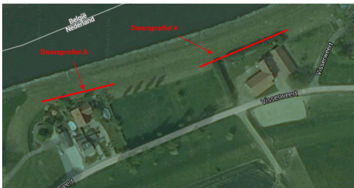
Figuur 5.1: Bovenaanzicht Visserweert met locaties damwanden
