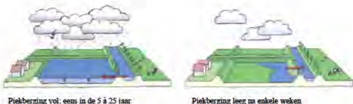
Figuur 2: Schematische weergave piekbergingsprincipe
