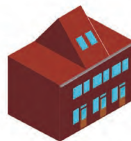
Dakopbouw op plat dak met de nok evenwijdig aan de gevel
