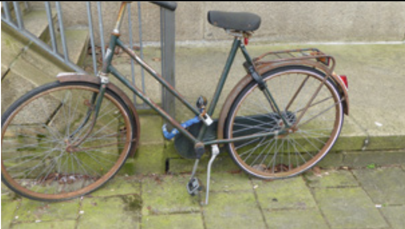
Lege banden, roest, dof zadel, vuil rond banden
