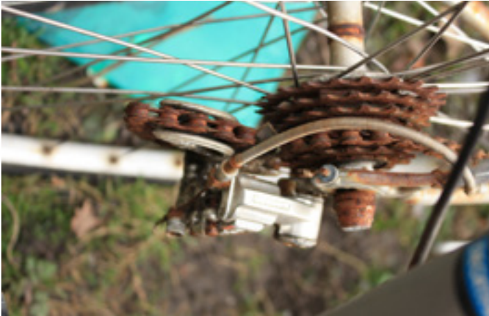
Derailleur en bediening derailleur beschadigd
