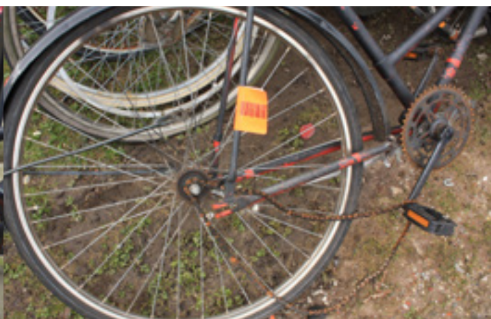
Wiel niet goed bevestigd, ketting eraf, onderdelen ontbreken
