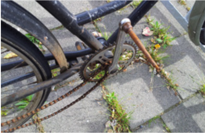
Ketting niet op tandwielen; kapotte trapper
