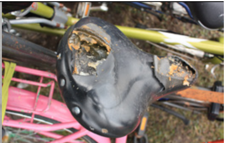
Zadel ernstig beschadigd
