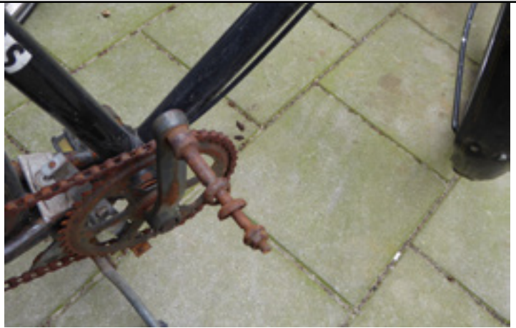
Verroeste ketting en kapotte trapper
