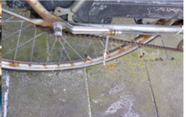
Versnellingsnaaf kapot, verroest kettinkje
