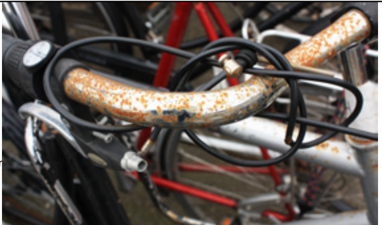
Ontbrekende en onklare remkabels
