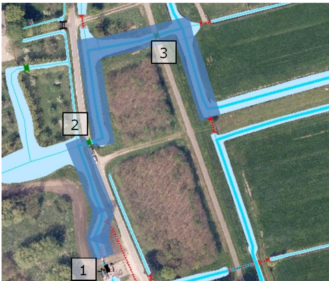
Figuur 1: Voorgestelde trace waarlangs de watergang verbreedt moet worden, inclusief de locatie van het gemaal (1) en beide duikers (2 en 3).
