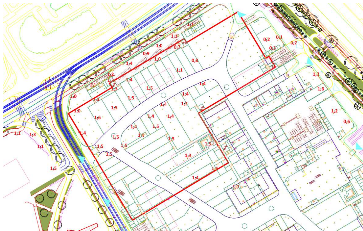
Figuur 5-1 Benodigde stijghoogteverlaging keldervloer (ten opzichte van NAP -2,0 m)
