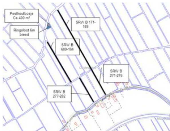
Figuur 4 te dempen sloten ten behoeve van aanleg maalvliet
