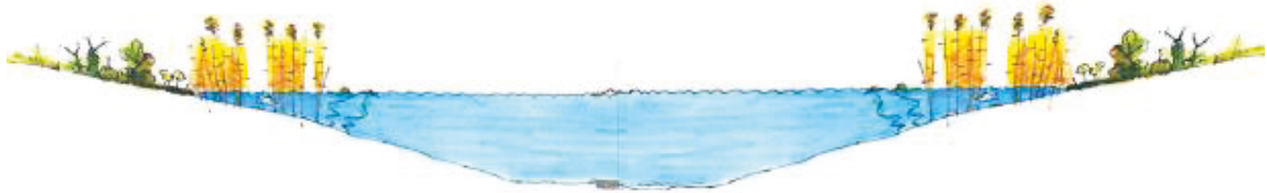
Figuur 4.4 Principeprofiel natuur- en visvriendelijke oevers laaggelegen middengebied
