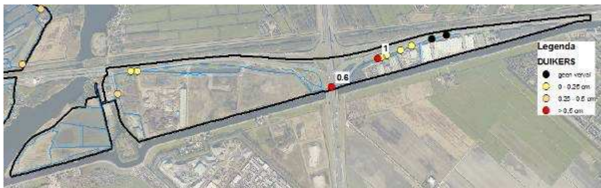
Figuur 6.17: verval duikers in Rottepolder
