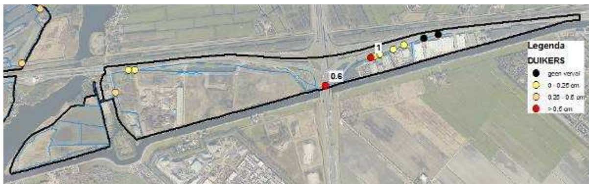
Figuur 6.17: verval duikers in Rottepolder
