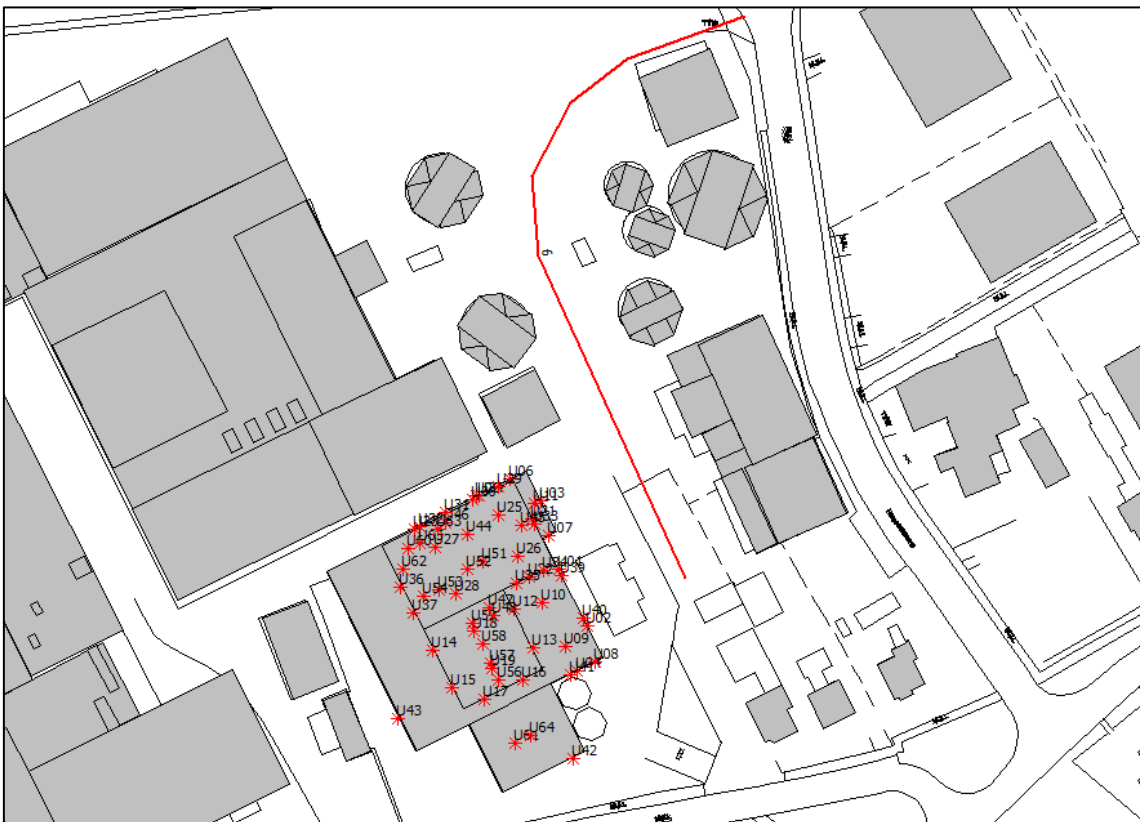
Afbeelding 2: Nieuwe geluidsbronnen in het Utility gebouw (voormalige Berkelcentrale)
