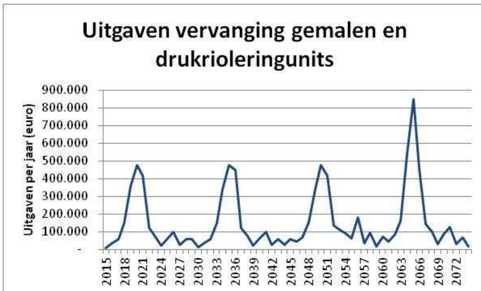
Figuur 6-A Kosten vervanging gemalen en drukrioleringunits
