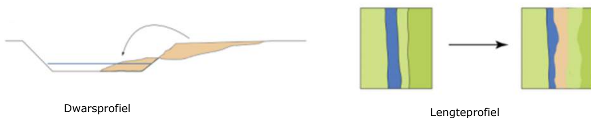
Figuur 15: schematische weergave van het ontgraven en inbrengen van grond in het dwars- en lengteprofiel
