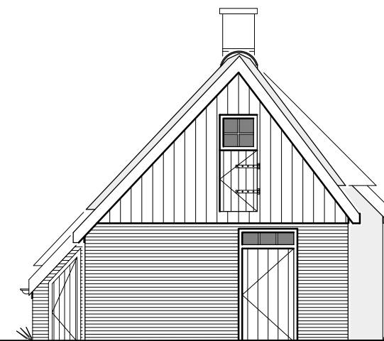
Achtergevel bestand staldeur was weggepleisterd in bestand
