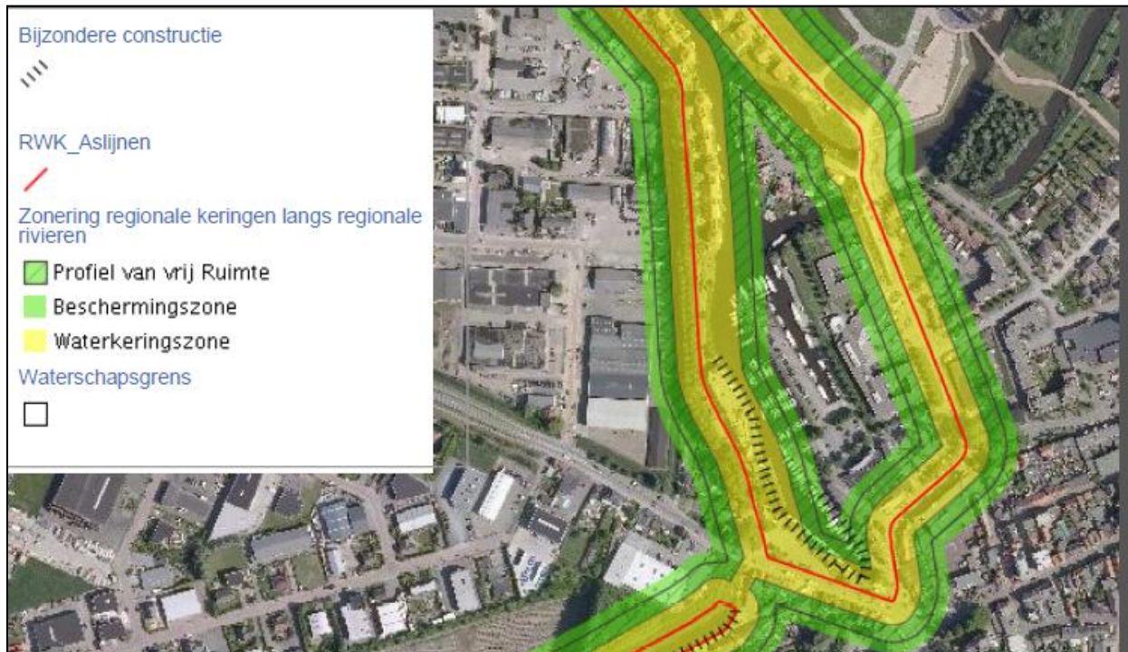
Afbeelding 2. Zonering waterkering haven steenberg.
