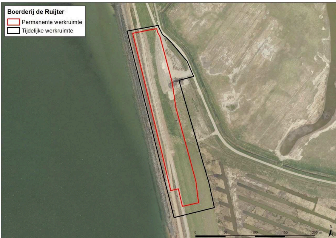
Figuur 1: Ligging van het projectgebied. Permanente werkruimte is het ruimtebeslag als gevolg van de herinrichting. De tijdelijke werkruimte is het aanvullend ruimtebeslag voor de duur van de werkzaamheden.
