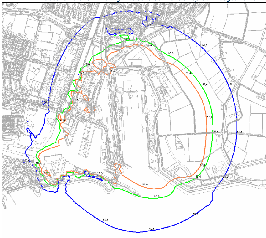
Figuur C.7.2: Ligging van de 50 (blauw), 55 (groen) en 57 (oranje) dB(A)-contour van de autonome ontwikkeling met Scheldekwardier op een hoogte van 5 meter.
