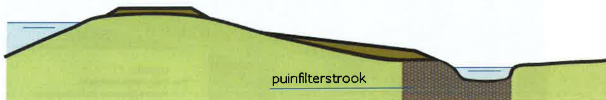
Figuur 1 Principe Kruinverhoging met bermaanleg, met of zonder aanbrengen van een puinfilterstrook(B4).
