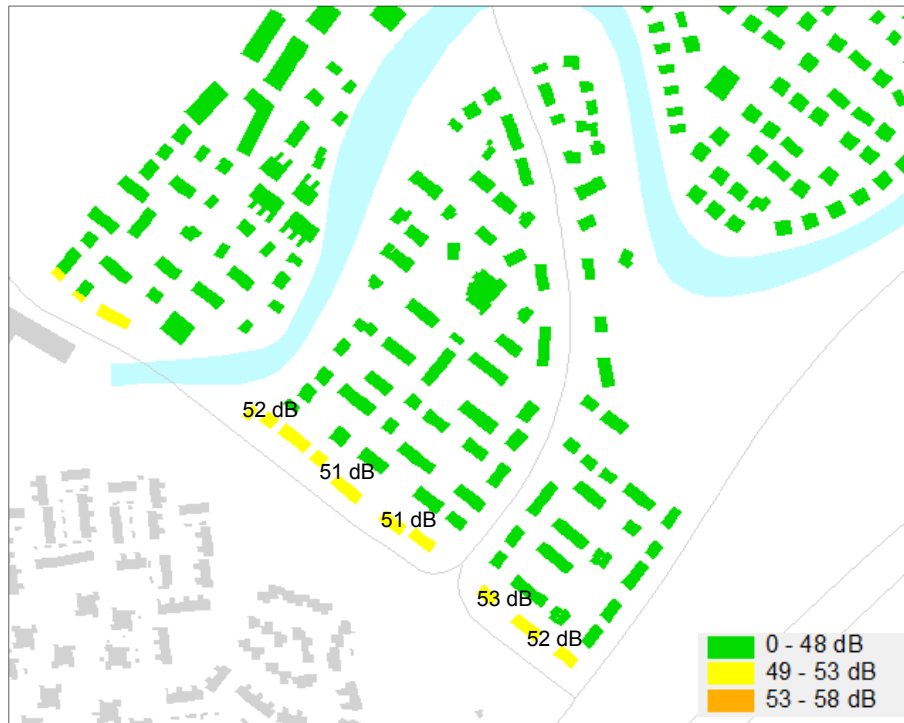
Figuur 4.11: Geluidsbelasting ten gevolge van Stroomzijde, inclusief geluidsreducerend asfalt en correctie conform artikel 110g
