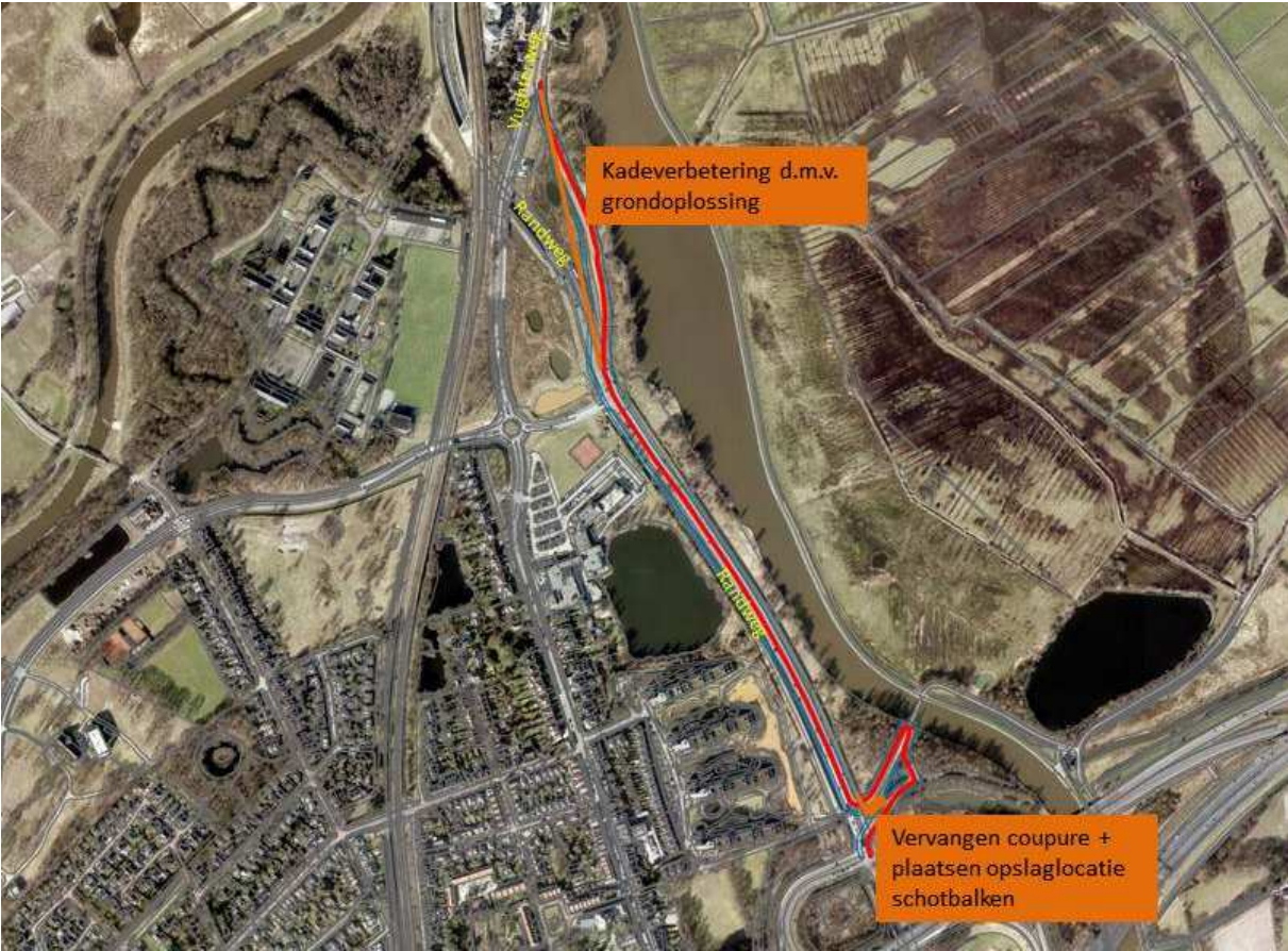
Figuur 2.1: Gekozen oplossingsrichtingen voor kadevak a en kadevak c
