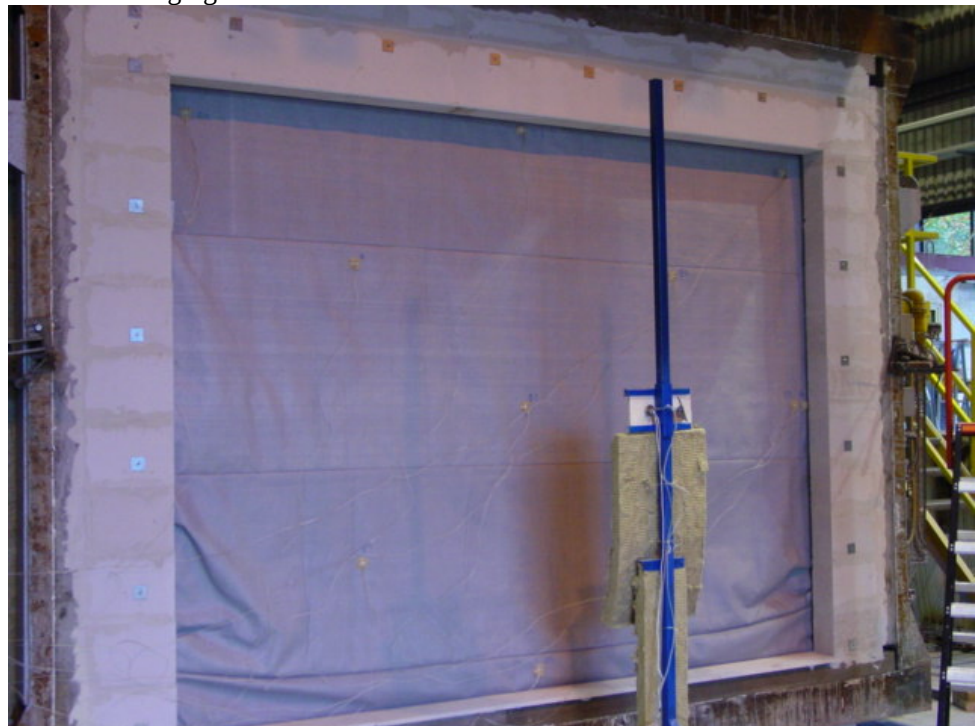
Foto 6: Brandscherm opgesteld voor de oven.
