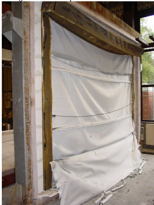
Foto 10: Vuurzijde brandscherm na de proef.
