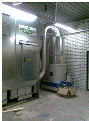
Brikettenpers 70N voorzien van cycloon als voorafscheider van de filterunit
