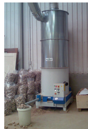
Brikettenpers Mythos voorzien van cycloon als voorafscheider van de filterunit
