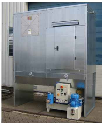
Brikettenpers 70N aangepast onder filterunit
