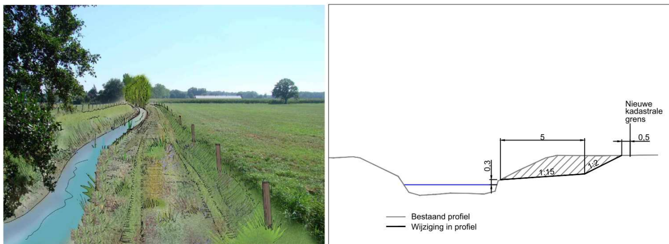
Figuur 1: Schematisatie inrichting overstromingszone: rechts de standaard maatvoering in meters van profiel van ontgraving, links een visualisatie van het eindbeeld (lage zone langs de beek stroomt circa 25 dagen per jaar onder water)
