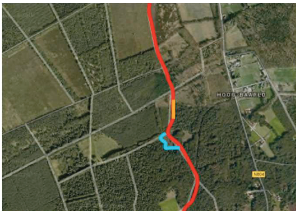
Afbeelding 3.4 Deel van het aan te leggen fietspad, in oranje het bruggetje over de slenk weergegeven. In blauw het om te leggen fietspad weergegeven.
